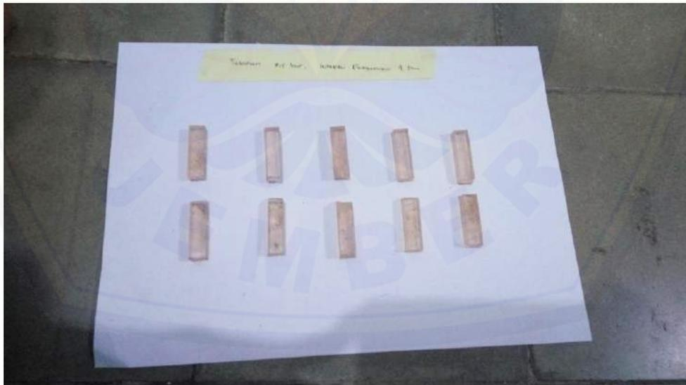
31. Gambar spesimen sebelum uji *impact* pada tekanan 0,5 bar dan waktu pengerasan selama 6 jam.
