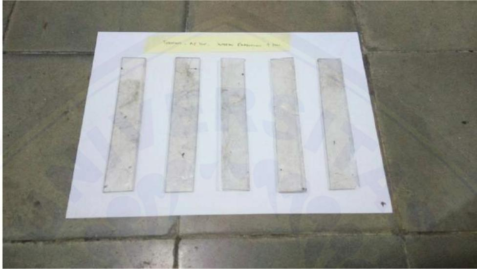
11. Gambar spesimen setelah uji tarik pada tekanan 0,5 bar dan waktu pengerasan selama 4 jam.
