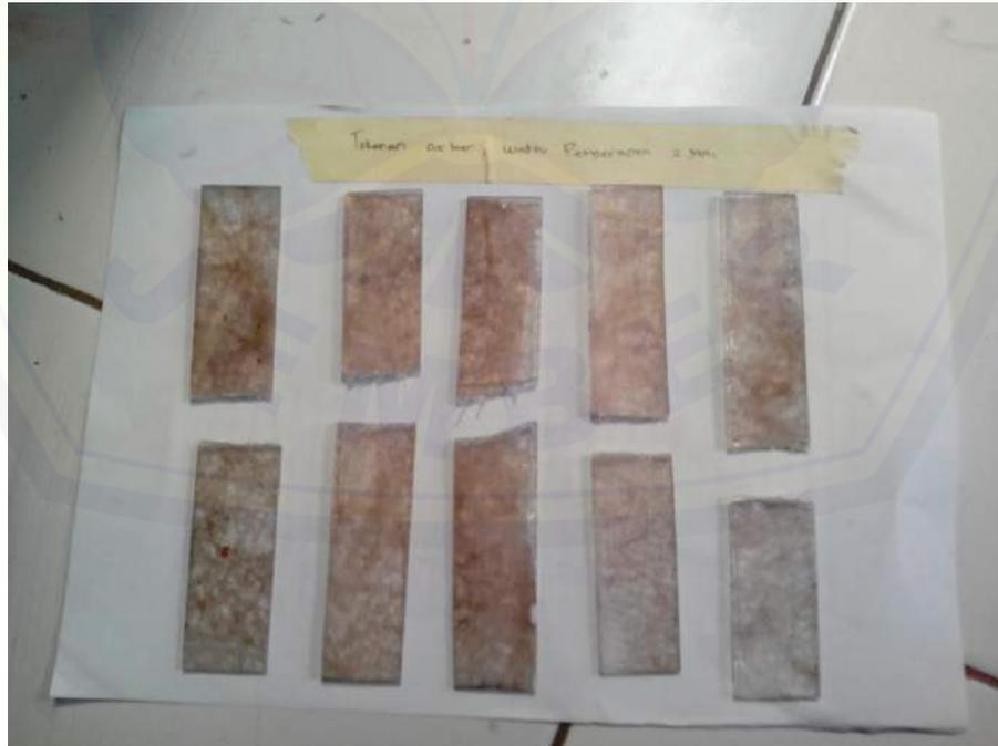
10. Gambar spesimen sebelum uji tarik pada tekanan 0,5 bar dan waktu pengerasan selama 4 jam.
