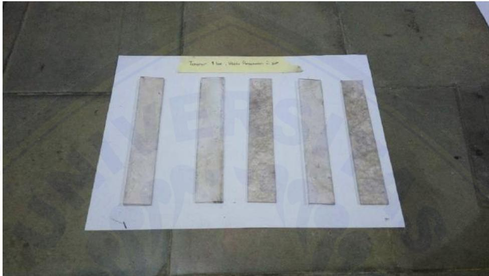
15. Gambar spesimen setelah uji tarik pada tekanan 1 bar dan waktu pengerasan selama 2 jam.
