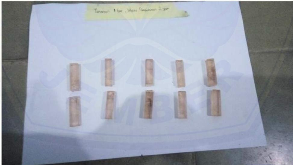
35. Gambar spesimen sebelum uji *impact* pada tekanan 1 bar dan waktu pengerasan selama 4 jam.
