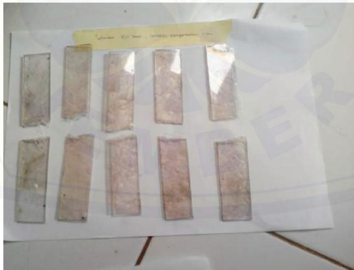
4. Gambar spesimen sebelum uji tarik pada tekanan 0,2 bar dan waktu pengerasan selama 4 jam.
