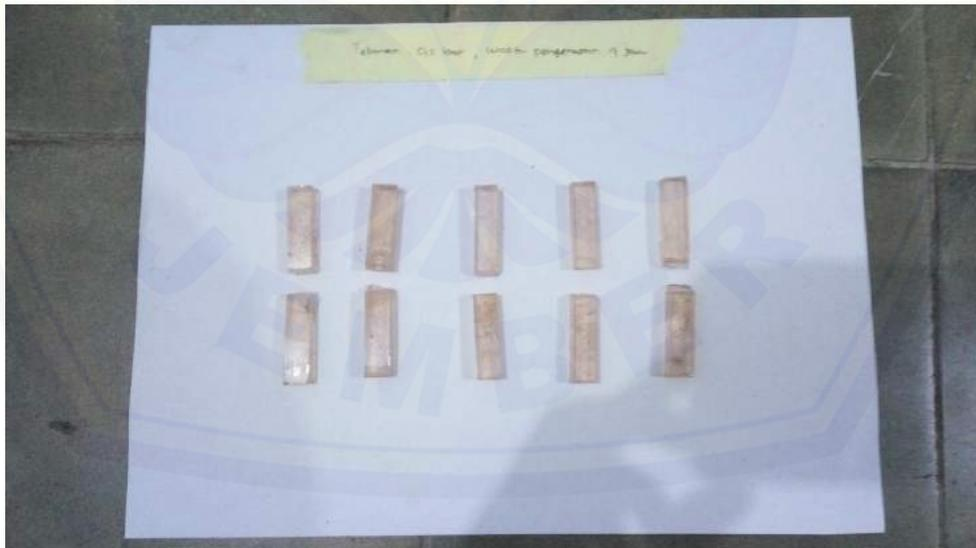
25. Gambar spesimen sebelum uji *impact* pada tekanan 0,2 bar dan waktu pengerasan selama 6 jam.
