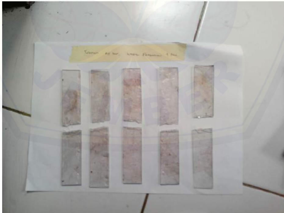
12. Gambar spesimen sebelum uji tarik pada tekanan 0,5 bar dan waktu pengerasan selama 6 jam.
