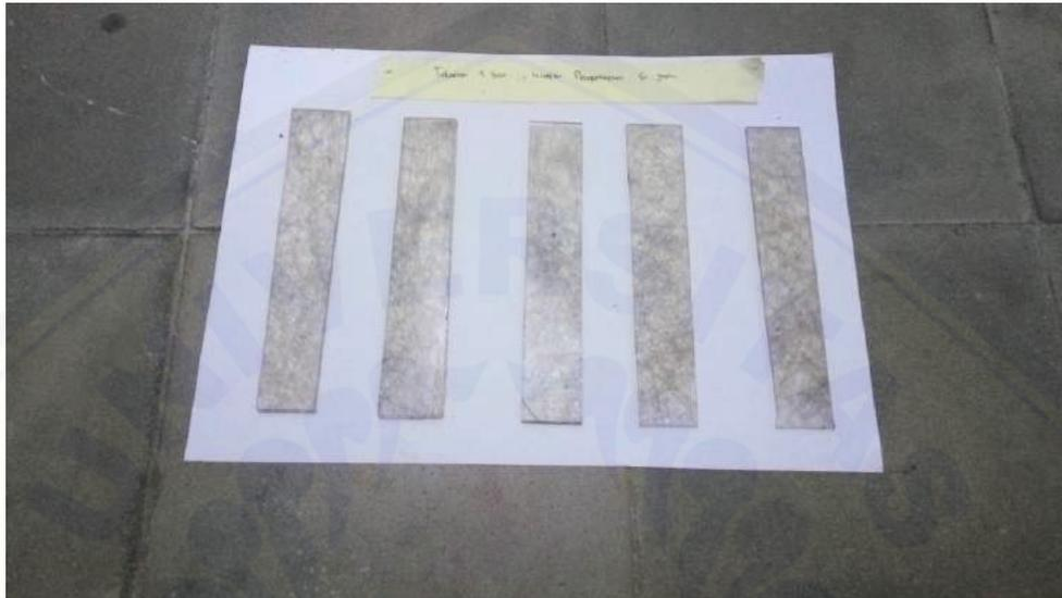
19. Gambar spesimen setelah uji tarik pada tekanan 1 bar dan waktu pengerasan selama 6 jam.
