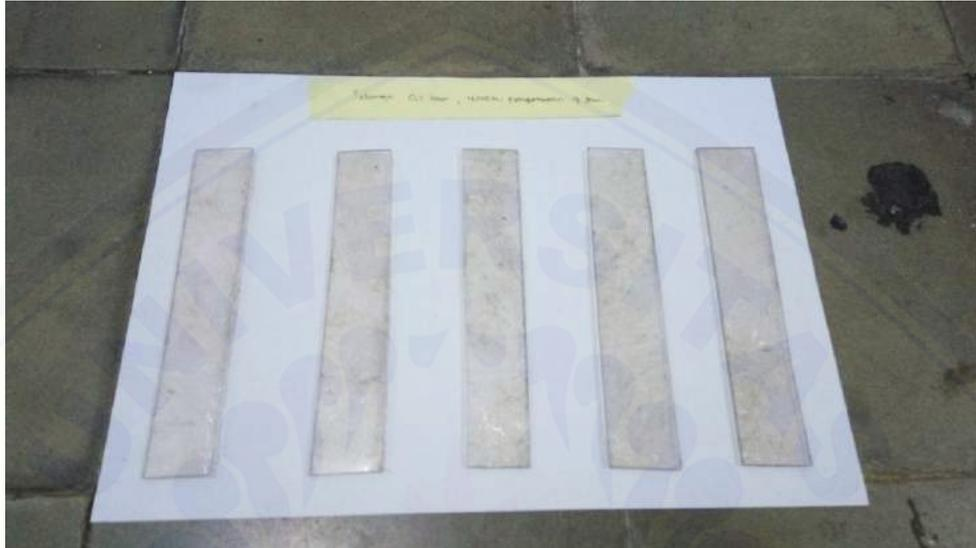
5. Gambar spesimen setelah uji tarik pada tekanan 0,2 bar dan waktu pengerasan selama 4 jam.
