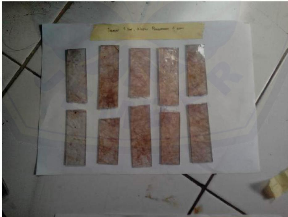
18. Gambar spesimen sebelum uji tarik pada tekanan 1 bar dan waktu pengerasan selama 6 jam.
