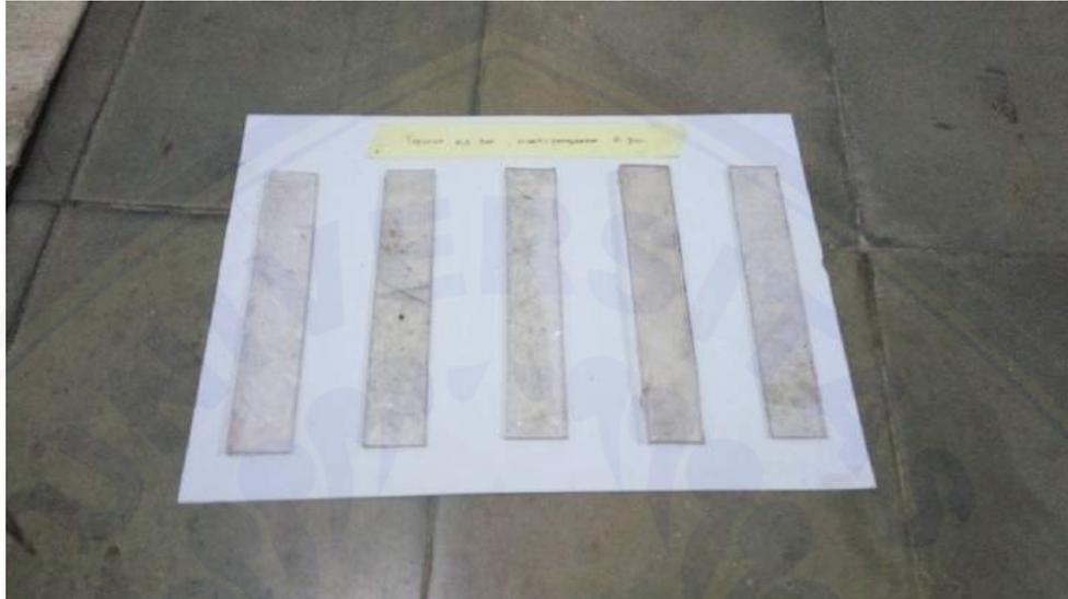
13. Gambar spesimen setelah uji tarik pada tekanan 0,5 bar dan waktu pengerasan selama 6 jam.
