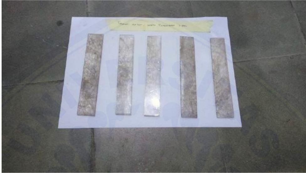
9. Gambar spesimen setelah uji tarik pada tekanan 0,5 bar dan waktu pengerasan selama 2 jam.
