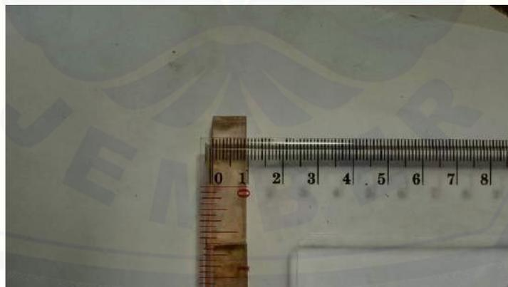
21. Gambar spesimen sebelum uji *impact* pada tekanan 0,2 bar dan waktu pengerasan selama 2 jam.
