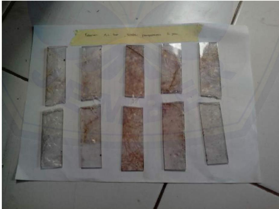
8. Gambar spesimen sebelum uji tarik pada tekanan 0,5 bar dan waktu pengerasan selama 2 jam.
