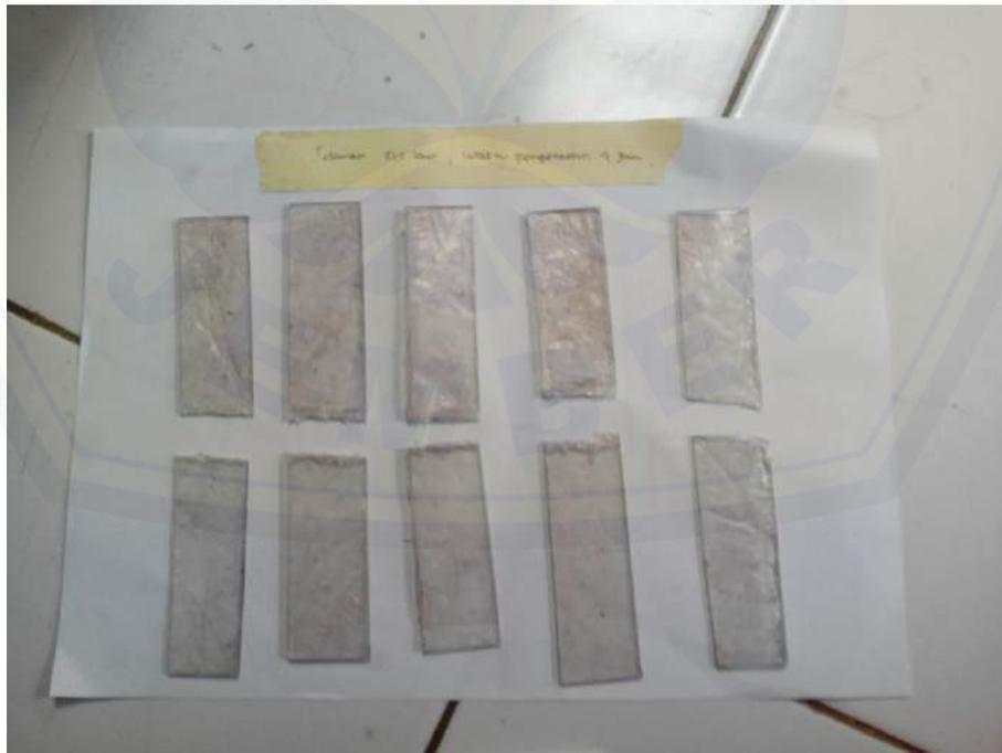
6. Gambar spesimen sebelum uji tarik pada tekanan 0,2 bar dan waktu pengerasan selama 6 jam.
