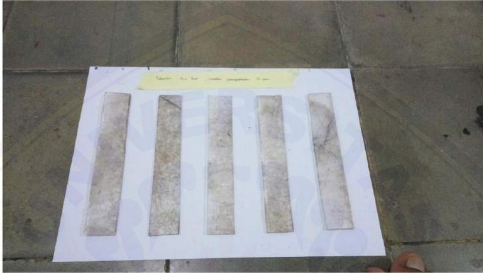
7. Gambar spesimen setelah uji tarik pada tekanan 0,2 bar dan waktu pengerasan selama 6 jam.
