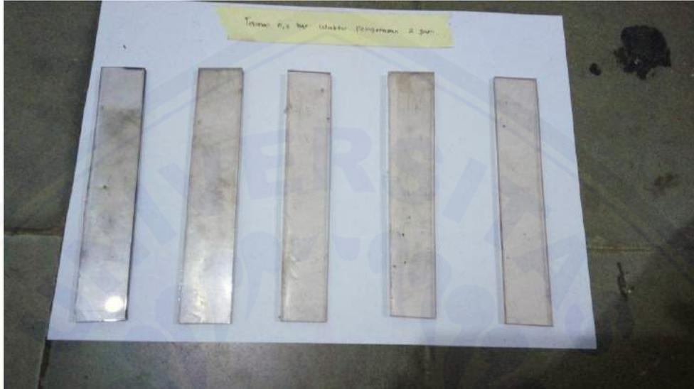
3. Gambar spesimen setelah uji tarik pada tekanan 0,2 bar dan waktu pengerasan selama 2 jam.
