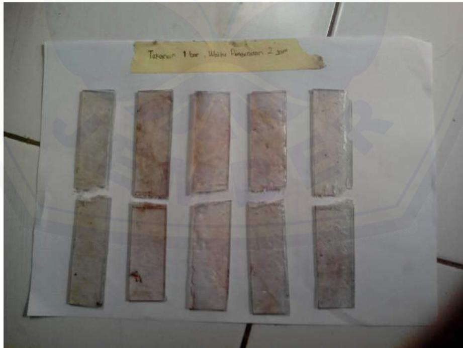
16. Gambar spesimen sebelum uji tarik pada tekanan 1 bar dan waktu pengerasan selama 4 jam.
