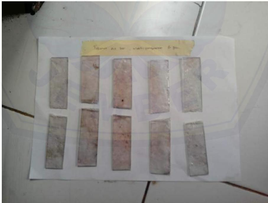
14. Gambar spesimen sebelum uji tarik pada tekanan 1 bar dan waktu pengerasan selama 2 jam.
