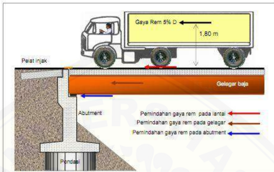
Gambar 2.6 Gaya rem dari beban lajur “D”.
