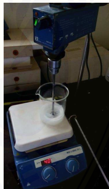
Pengadukan Menggunakan Four Blades Propeller
