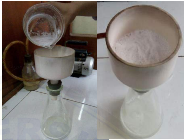
Penyaringan Menggunakan Kertas Whatmann No. 1 dengan Bantuan Vacum Filtration
