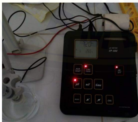
Pengujian pH larutan dapar fosfat pH 7,2 menggunakan pH tester
