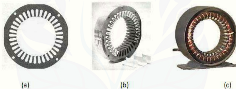
Gambar 2.2. Komponen stator motor induksi tiga fasa. (a) Lempengan inti, (b) Tumpukan inti dengan isolasi kertas, (c) Tumpukan inti dan kumparan dalam cangkang stator.
