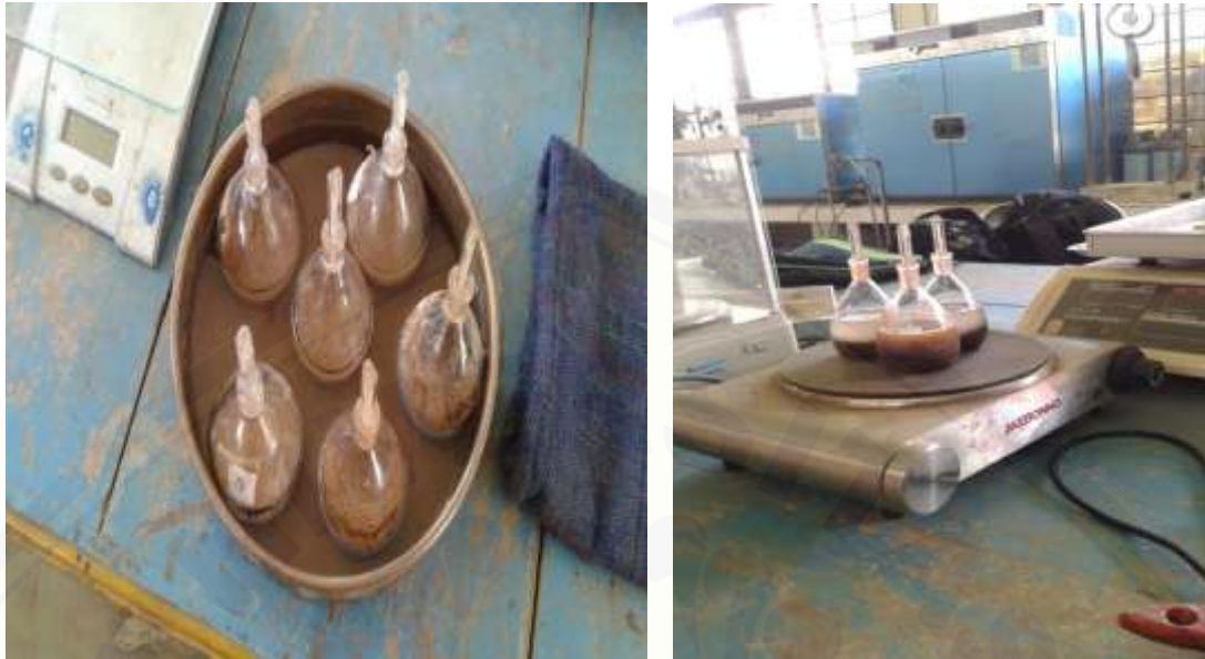
Gambar C3. Pengujian berat jenis tanah asli
