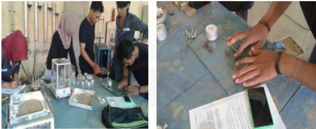
Gambar C4. Pengujian atteberg limmit
