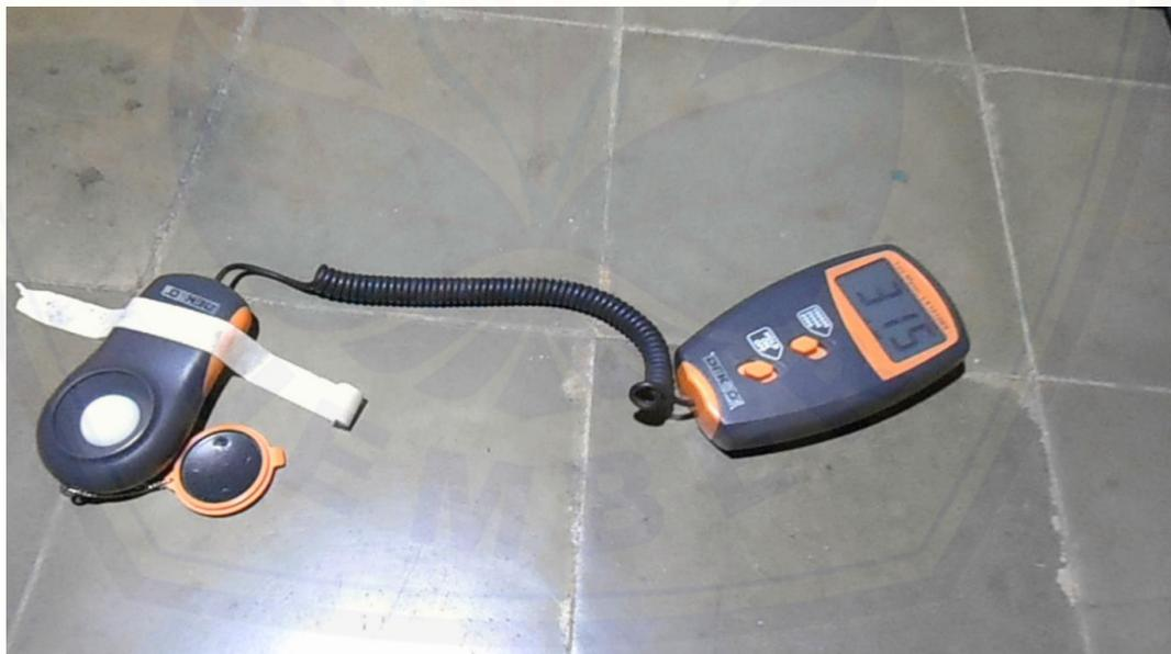
Gambar 6. Salah satu data kuat penerangan yang terbaca Luxmeter
