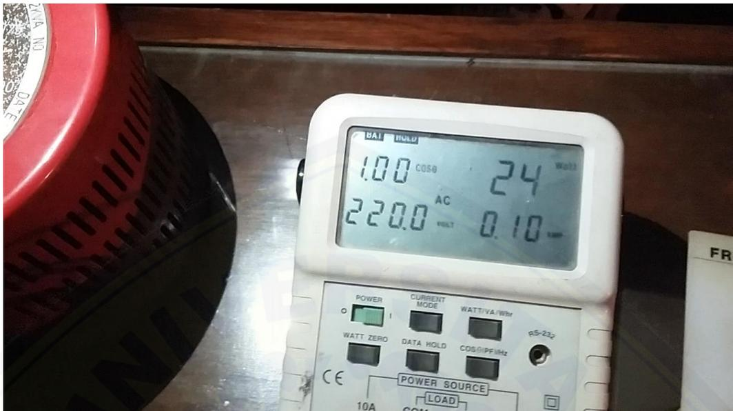
Gambar 5. Salah satu data daya aktif yang terbaca Power Analyzer
