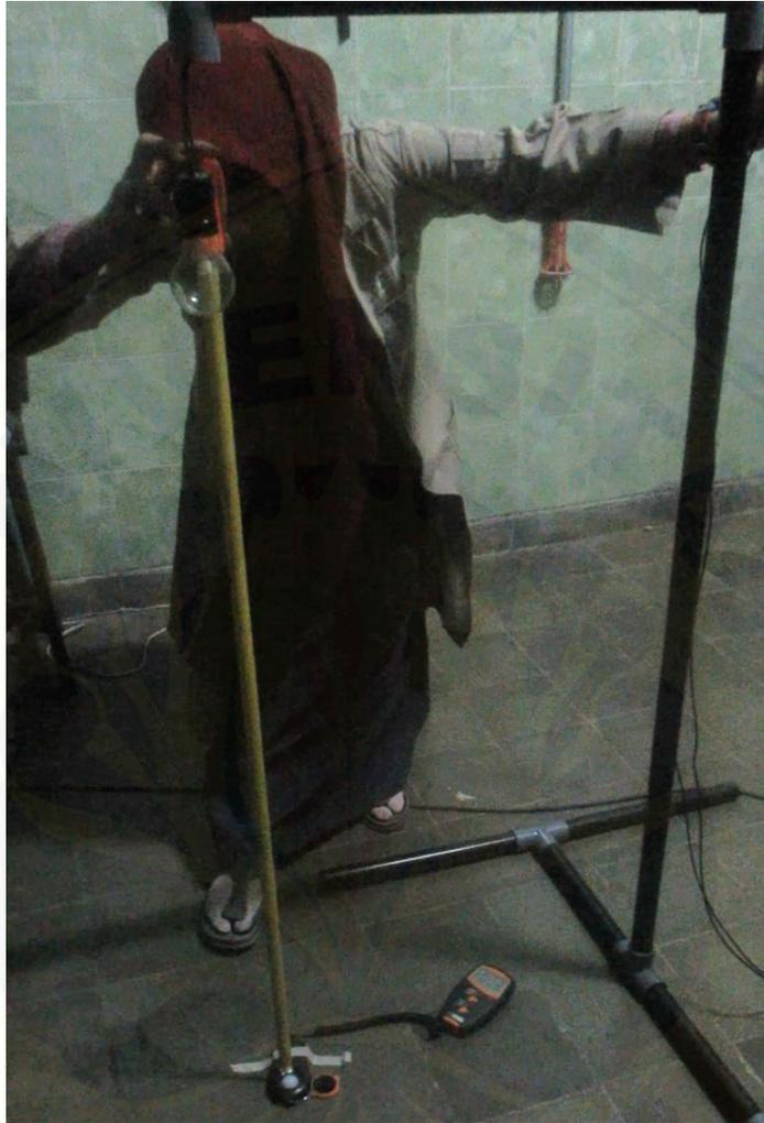
Gambar 4. Pengukuran jarak antara lampu yang diuji dengan sensor cahaya luxmeter
