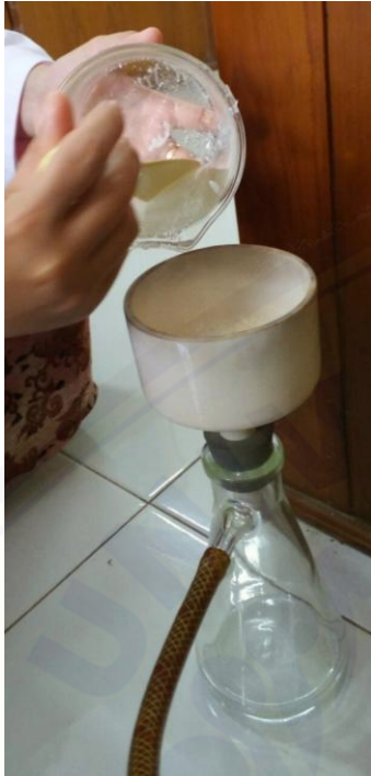
Proses penyaringan microspheres menggunakan corong buchner
