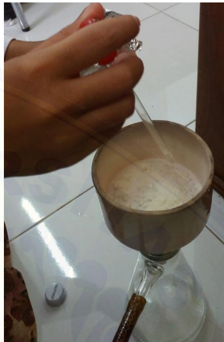
Proses pencucian microspheres dengan Petroleum ether
