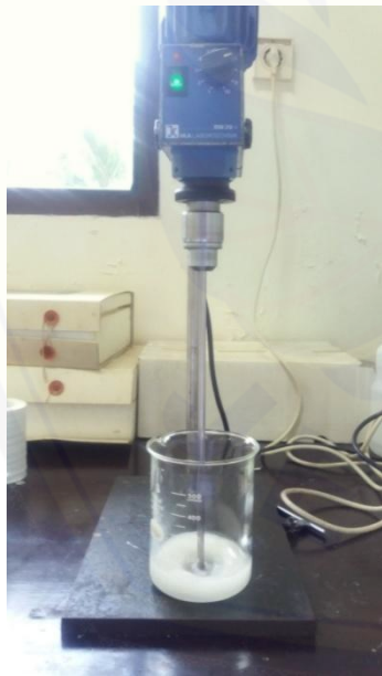
Proses pengadukan dengan four blades propeller
