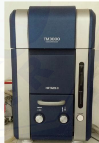
Karakterisasi ukuran dan morfologi microspheres dengan SEM
