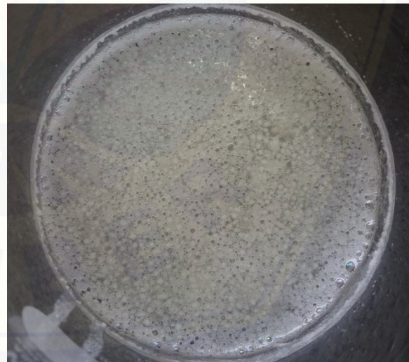
Microspheres yang terbentuk setelah proses pengadukan dengan four blades propeller
