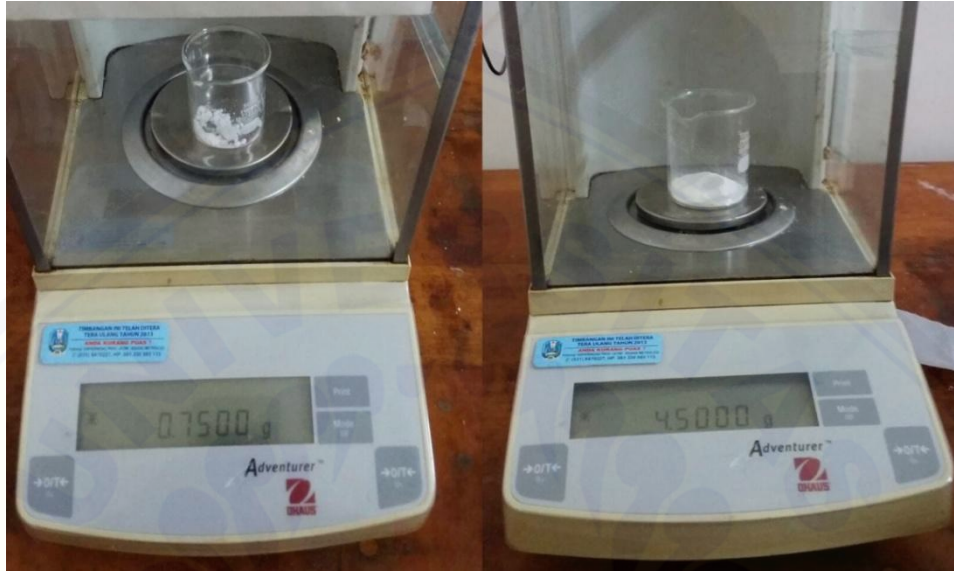
Proses penimbangan bahan aktif dan polimer menggunakan timbangan analytic digital
