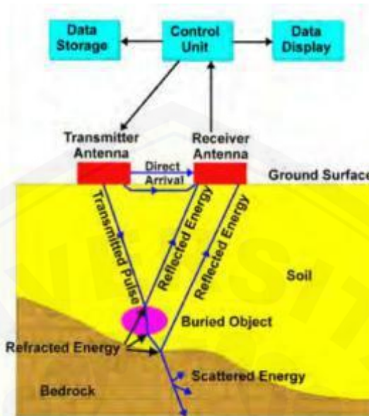
Gambar 2.4 Prinsip Kerja Alat GPR (Huda, 2011).
