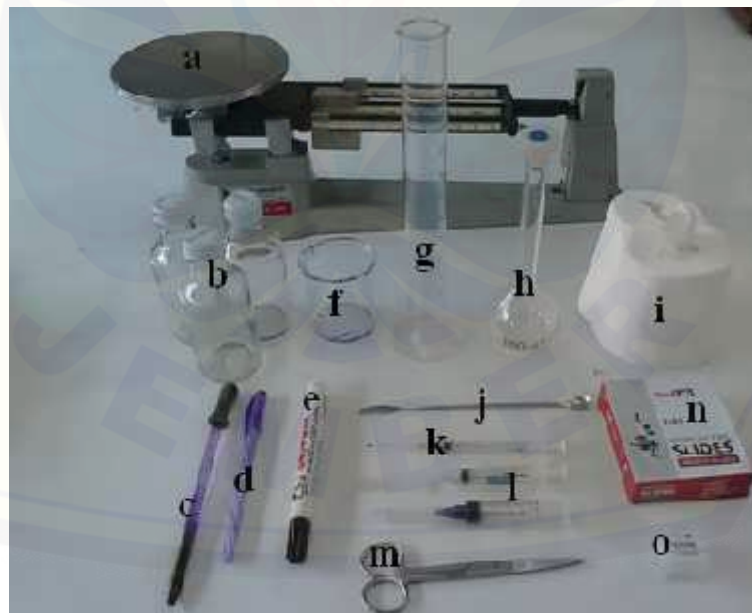
Gambar 2. Alat penelitian a) neraca ohaus, b) botol, c) pipet, d) bolpoin, e) spidol, f) beaker glas, g) gelas ukur, h) labu ukur, i) tisu, j) spatula, k) sonde, l) spuit, m) gunting, n) kaca penutup
