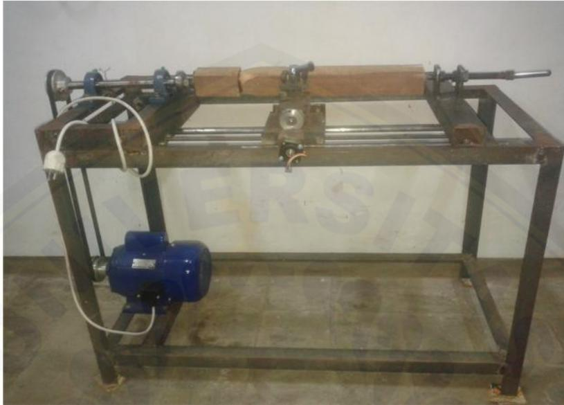
Gambar C.9 Mesin CNC bubut kayu
