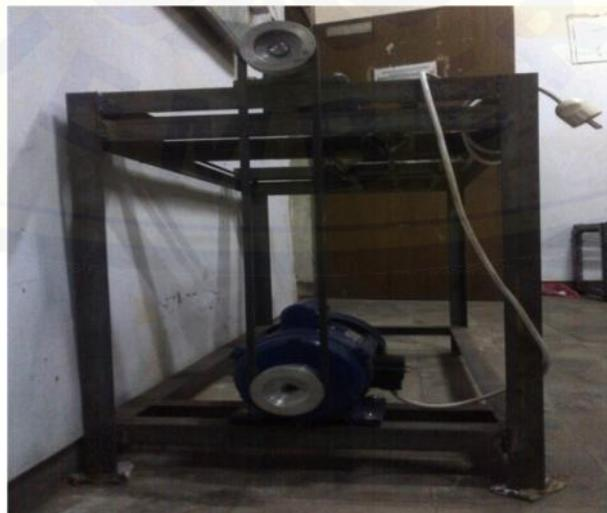
Gambar C.8 Penyetelan pulley dan sabuk
