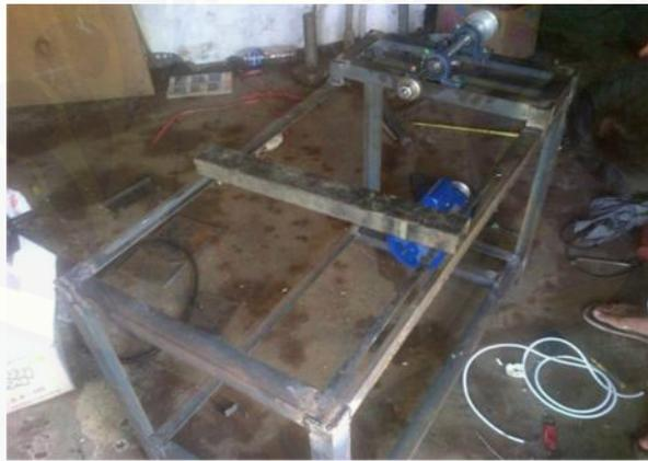
Gambar C.8 Pemasangan Tailstock
