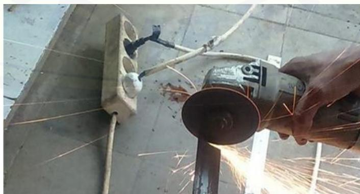
Gambar C.3 Pemotongan bahan (ST-37)
