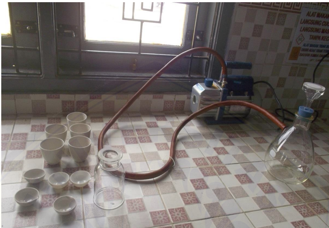
Gambar G.5 Set alat pengukuran parameter TDS dan TSS menggunakan metode Gravimetry
