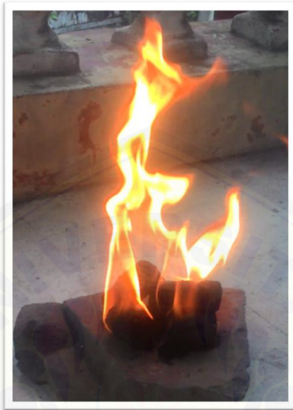
Gambar C.11 Menguji Kemampuan Bakar Briket dengan bantuan Minyak Tanah
