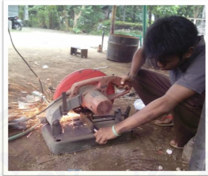
Gambar C.1 Pemotongan Pipa(Pembuatan Mekanisme Cetak)
