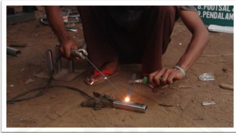
Gambar C.3 Pengelasan (Penyambungan Mekanisme Cetak)
