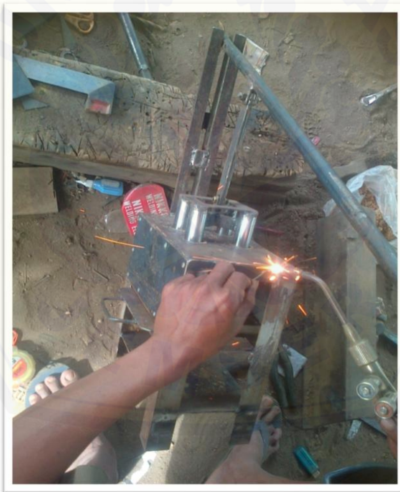
Gambar C.4 Penyempurnaan Alat menggunakan Las Asetelin
