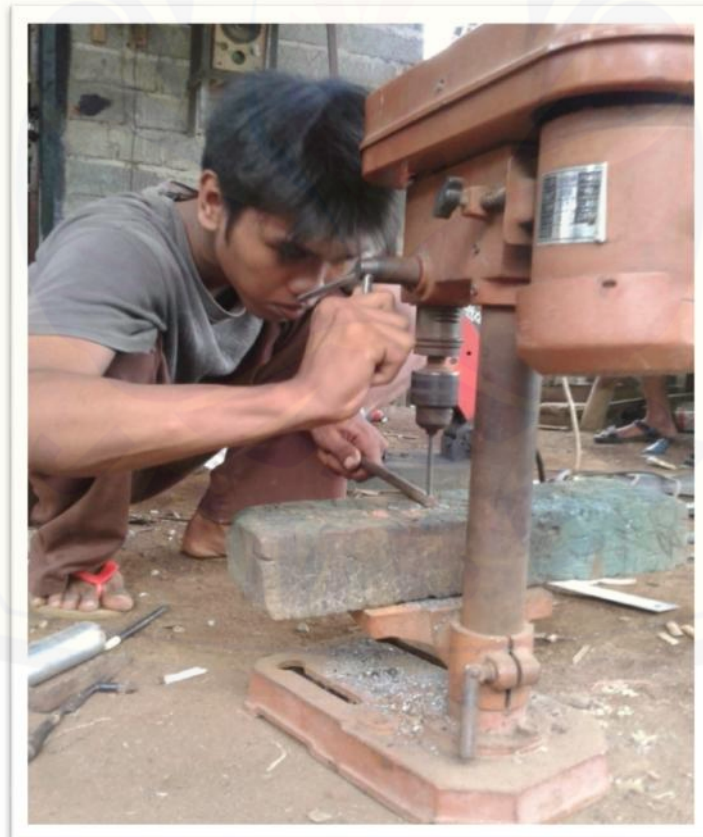
Gambar C.2 Pengeboran (Pembuatan Lubang pada Tuas Penekan dan Batang penghubung)
