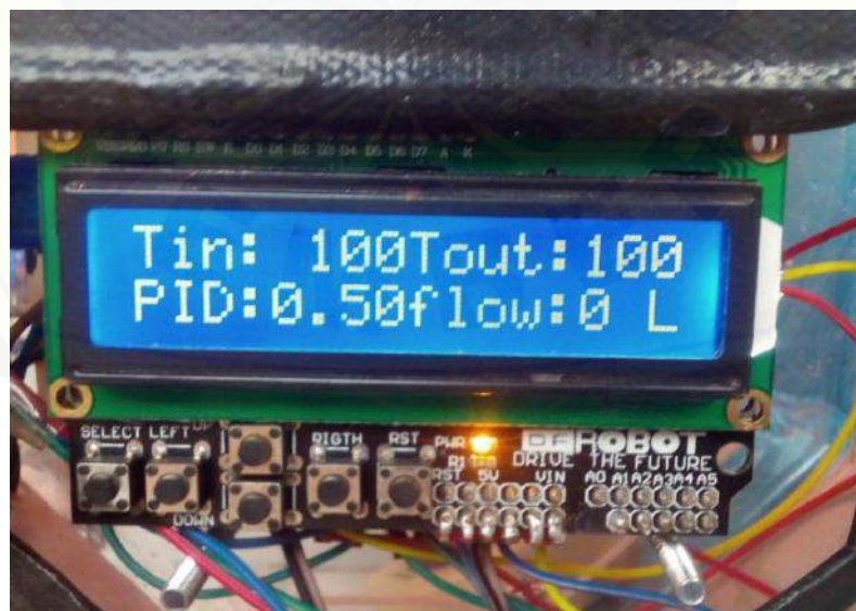
Gambar 3.7 Pembacaan Sensor Setelah dikalibrasi
