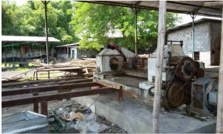
m. Mesin penggerajian log menjadi balkon atau STBR ( Sawn Timber )
