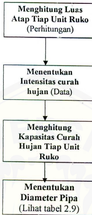
Gambar 3.9 Skema Untuk Menentukan Diameter Pipa Air Hujan
