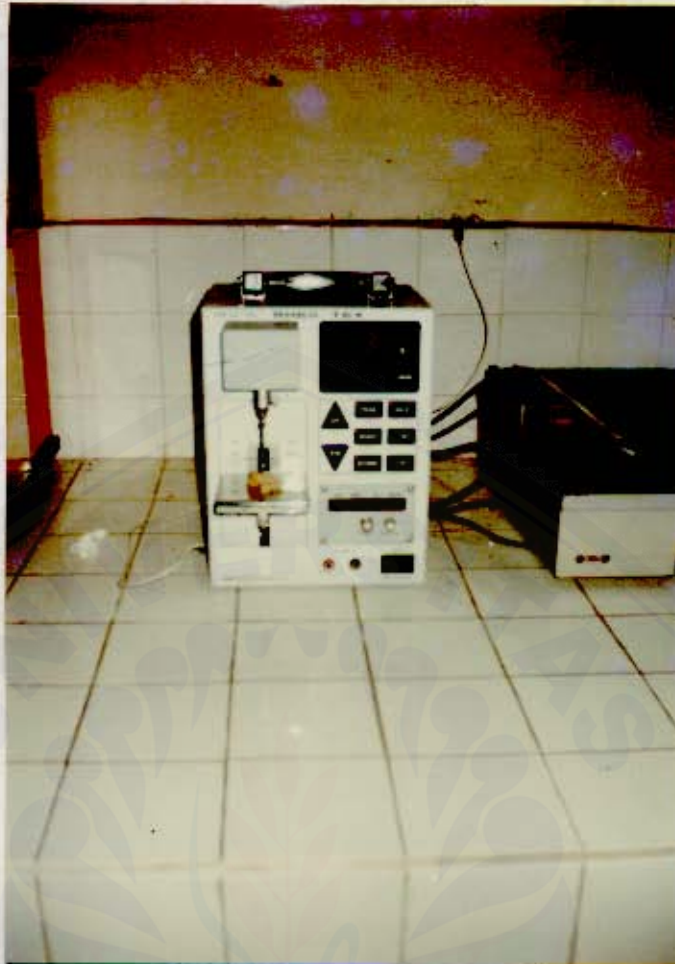
Gbr 1. Alat penetrometer digital RHEOTEX SD 700 untuk mengukur keempukan daging
