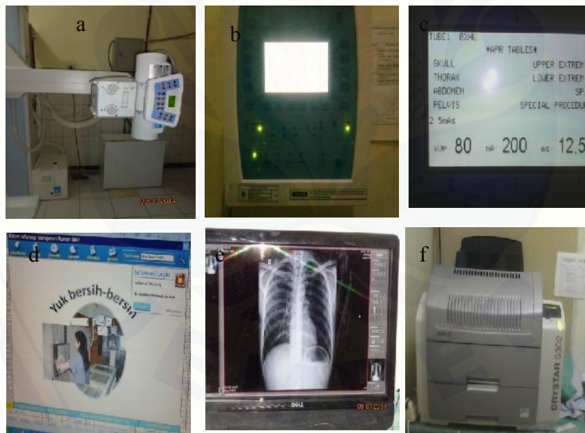
Gambar 3.1 Panel kontrol pesawat Rontgen Model G100C RAD No. Seri CPD 13358L12 : (a) Tabung sinar-X (b) Panel kontrol sinar-X (c) Masukan tegangan sinar-X (d) Sistem Informasi Managemen Rumah Sakit (e) Penghasil gambar foto thorax (f) Mesin print foto thorax.
