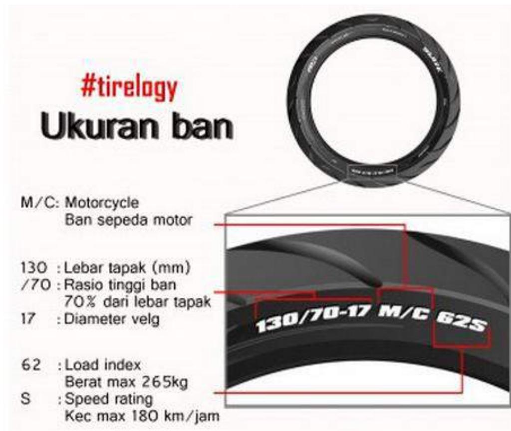
Gambar 2.2 Kode-kode pada Dinding Ban
