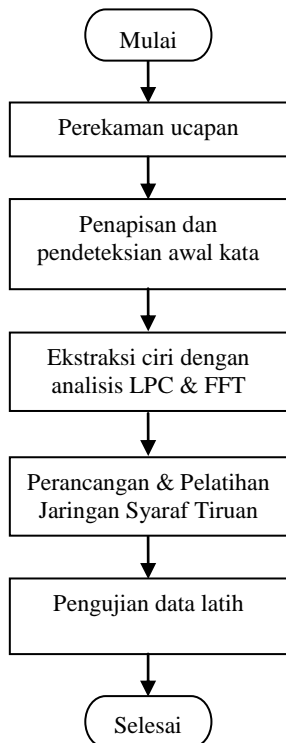
Gambar 3. Diagram alir sistem pengenalan kata pada mobile robot
