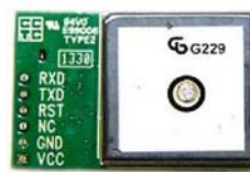
Gambar 4. Bentuk fisik SkyNav SKM53
