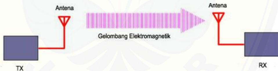
Gambar 2.1 peran antena di sistem komunikasi nirkabel
