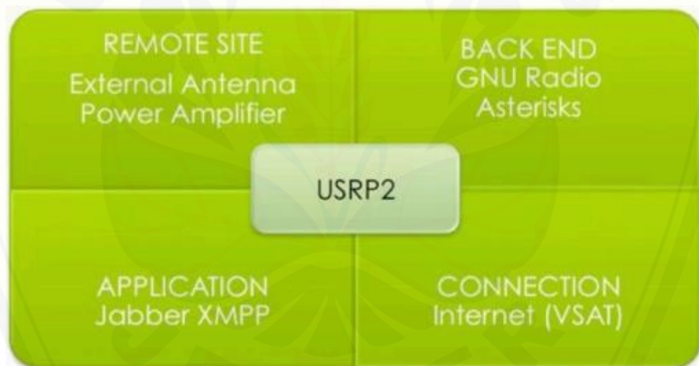
Gambar 2.5 Blok Diagram Arsitektur OpenBTS
