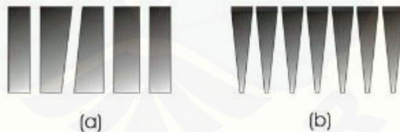
Gambar 2.2 Klasifikasi membran berdasarkan morfologi (a) simetri; (b) asimetri (Wenten, 2000)
