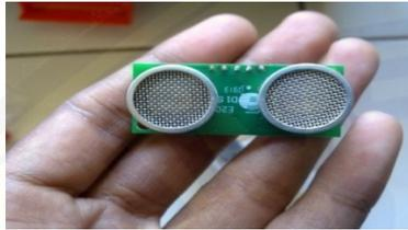
Gambar. 2 Sensor ultrasonik
