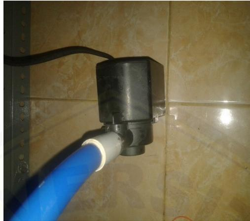
Gambar 3.4 Pompa Air
