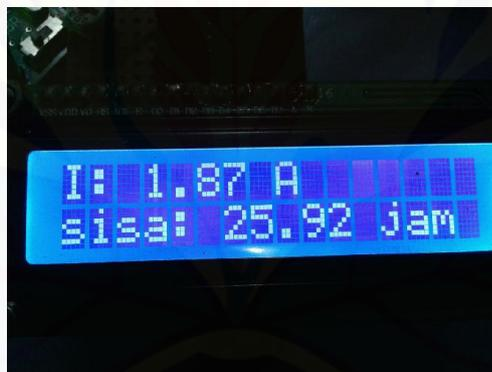
Gambar 4.8 Data hasil pengujian dengan beban 25W
