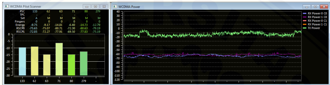
5.b Pengujian Bergerak Menggunakan Antena Mikrostrip Array Kecepatan 50 km/jam
