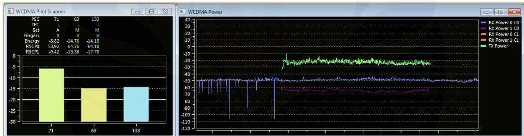
1.c Pengujian Bergerak Menggunakan Antena Pemandang Kecepatan 10 km/jam
