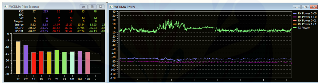
5c. Pengujian Bergerak Menggunakan Antena Pembanding Kecepatan 50 km/jam
