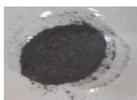
Gambar 4. Silikon hasil metalotermis dari *fly ash* batubara
