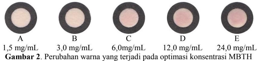
**Gambar 2.** Perubahan warna yang terjadi pada optimasi konsentrasi MBTH
