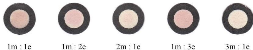
**Gambar 3.** Perubahan warna yang terjadi pada optimasi perbandingan volume reagen MBTH (m) dan enzim PPO (e)
