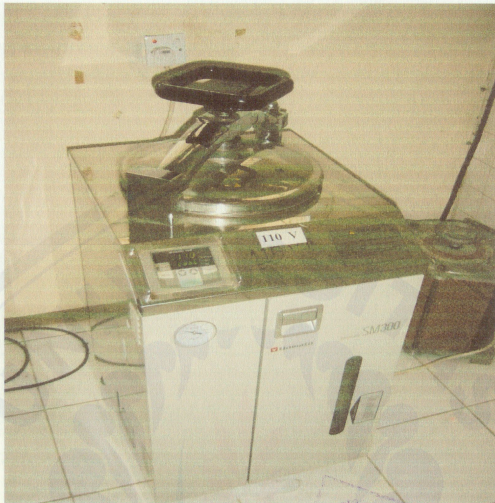
Foto autoclave, untuk mensterilkan media cair
