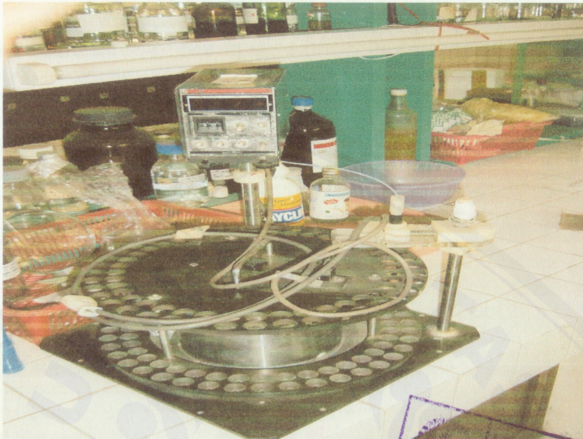
Foto fraksinasi, untuk fraksinasi enzim phytase Bacillus amyloliquefaciens
