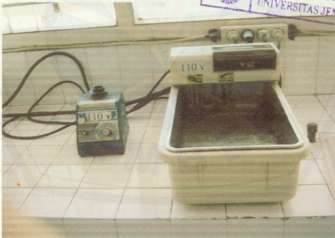
Foto Water bath, untuk menginkubasi reaksi enzim phytase Bacillus amyloliquefaciens
