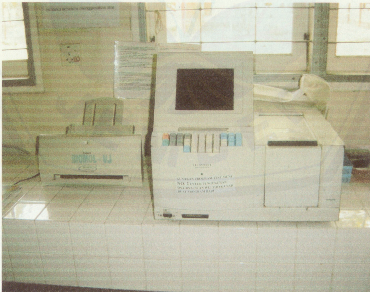
Foto spektrofotometer, untuk mengukur uji aktivitas dan kandungan protein
