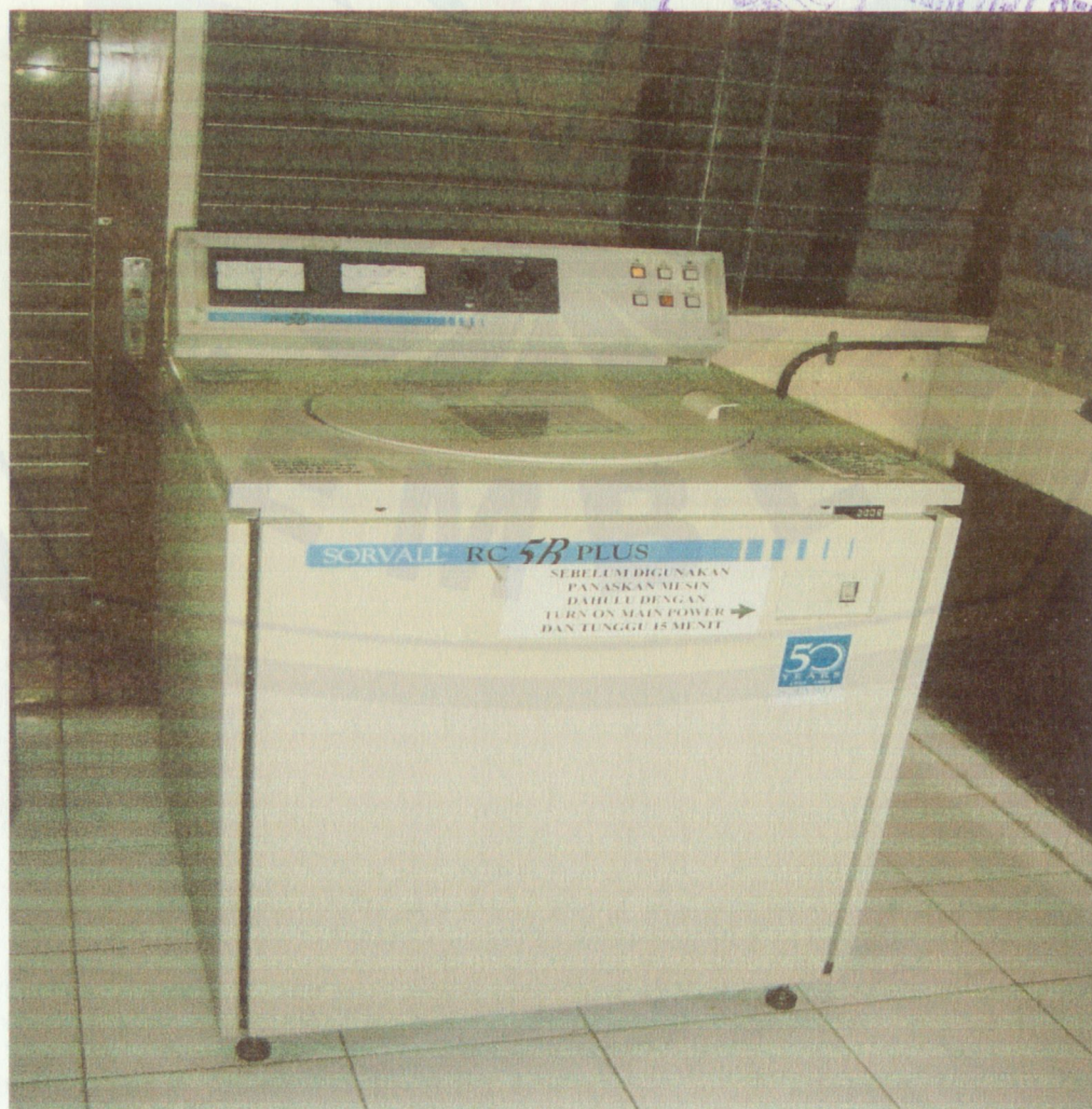
Foto sentrifuse, untuk memisahkan crude enzym
