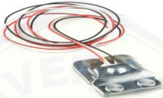
Gambar 2.4 Sensor berat ( Load Cell ) (Sumber dari jurnal Rizki Mulia Utama Jurusan teknik komputer AMIK GI MDP)
