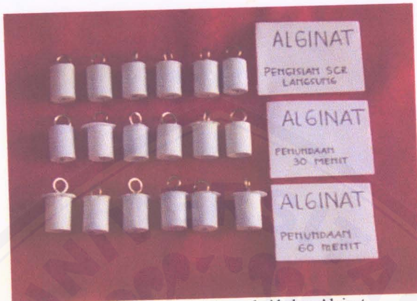
Gambar VI. Replika berbentuk tabung dari bahan Alginat.
