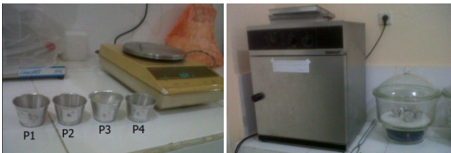
Gambar 2. Pengukuran kadar air metode gravimetri
