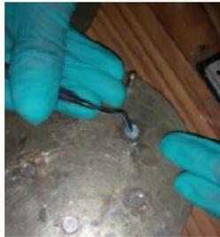
Gambar 3.4 Komposit yang dimanipulasi ke dalam *master mould*
