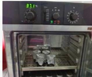
Gambar 3.14 Penyimpanan tabung pada inkubator
