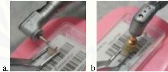
Gambar 3.10 a) *Finishing* pada sampel; b) *polishing* sampel
