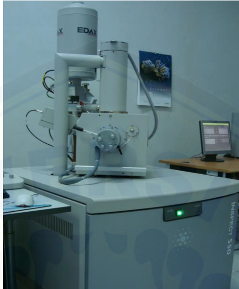
Gambar 3.9 Sampel dimasukkan dalam unit SEM
