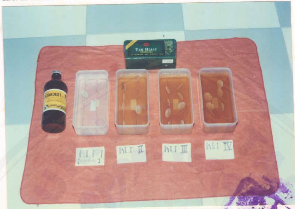
Gambar Perendaman Sampel Dalam Larutan Teh Hijau
