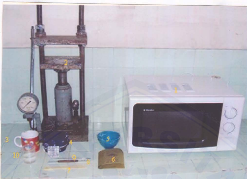
Gambar 8 : Alat dan Bahan, Keterangan : 1. Oven Microwave , 2. Press Hidrolik 3. Gelas Keramik (tempat mencampur bubuk dan cairan akrilik) 4. Kuvet Fiberglass 5. Mangkuk Karet, 6. Kertas Gosok 7. Spatula 8. Pisau Malam 9. Pisau gips 10. Mangkuk Air Pyrex
