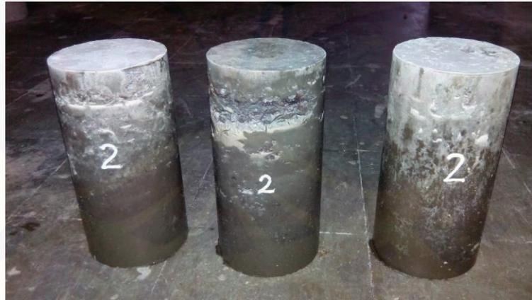
Gambar 2. Beton silinder 10x20 cm yang mengalami pengeroposan (gambar tengah)
