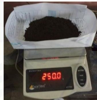
**F.3 Gambar Pengujian Agregat Halus**
