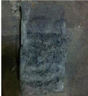
Gambar 1. Beton bentuk silinder 15x30 cm yang dibelah
