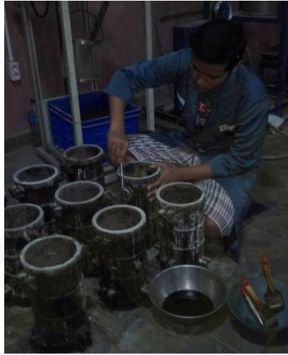
(a). Pembongkaran benda uji. (b). Benda uji setelah dilakukan curing.
