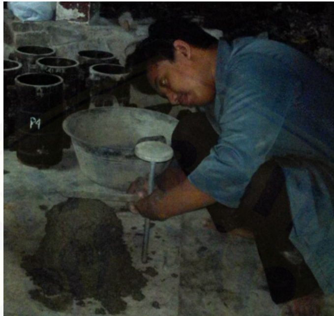
Gambar F.3 Pengujian slump
