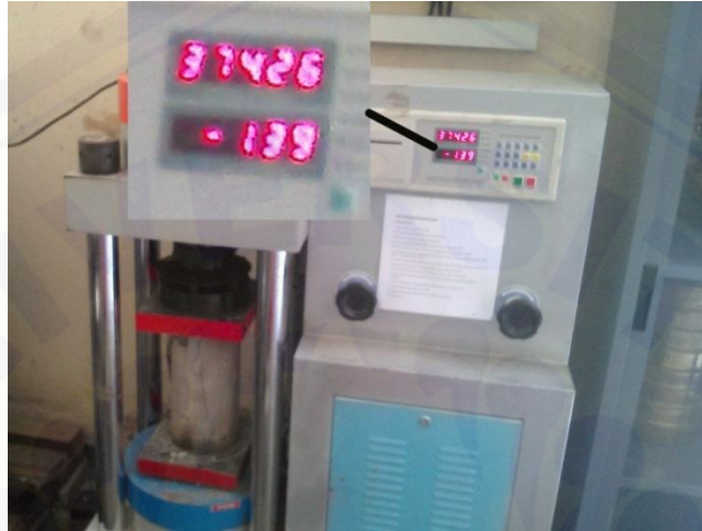
Gambar 4.8 Pengujian kuat tekan beton.
