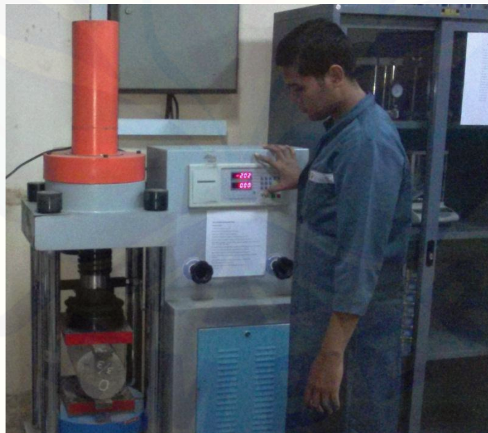
Gambar F.6 Pengujian kuat tarik belah beton
