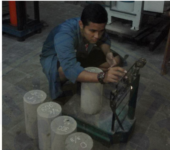
Gambar F.5 Menimbang benda uji yang sudah siap diuji
