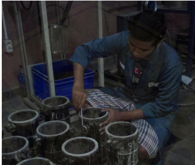
Gambar F.1 Menyiapkan cetakan silinder
