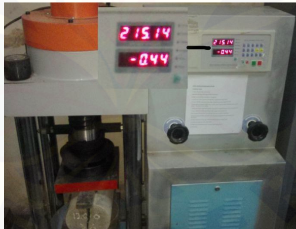
Gambar 4.5 Pengujian kuat tarik belah beton.
