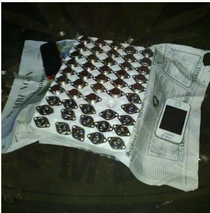
Gambar 2. Transistor 2N3055 yang belum dan sudah dibuka penutupnya
