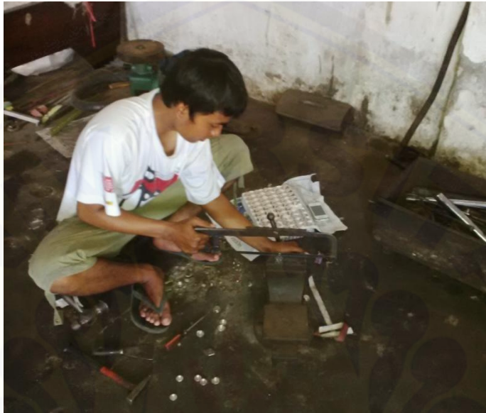
Gambar 1. Penggergajian penutup transistor 2N3055
