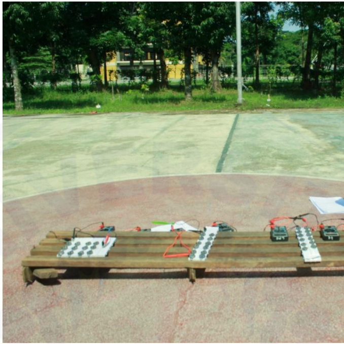
Gambar 3. Penyinaran transistor 2N3055
