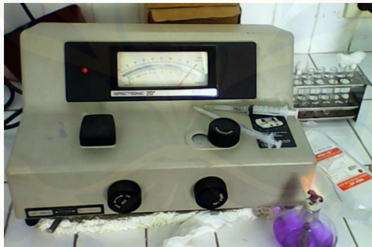
Gambar D.2.3 Penggunaan spektrofotometer untuk pengenceran bakteri E. coli sesuai standart Mac Farland
