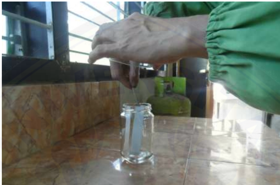
Gambar 3. Lempeng silika gel yang sudah ditotol dieluasi pada botol selai sebagai fase gerak
