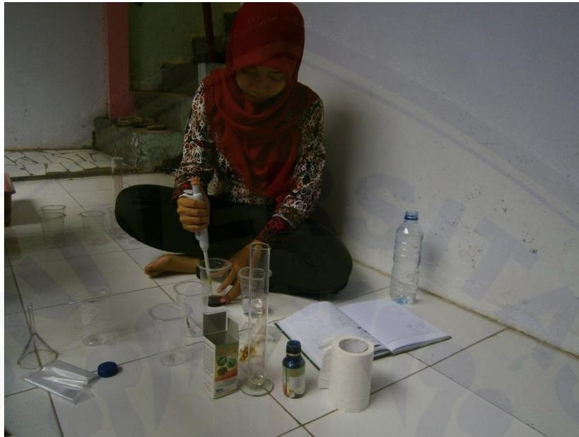
Gambar 1. Pembuatan Serial Konsentrasi Insektisida
