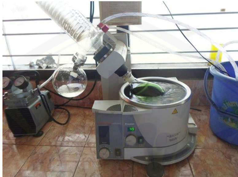
Gambar F.3 Pemekatan ekstrak menggunakan rotary evaporator
