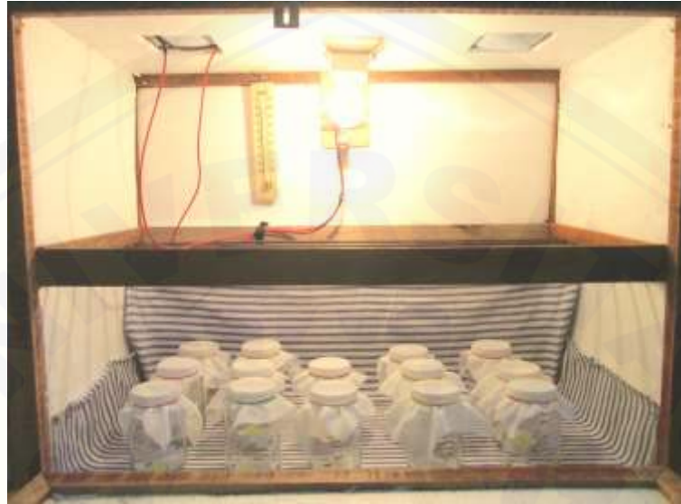
Gambar C1. Inkubator dan botol pemeliharaan yang digunakan sebagai tempat pemeliharaan dan perlakuan terhadap larva S. litura
