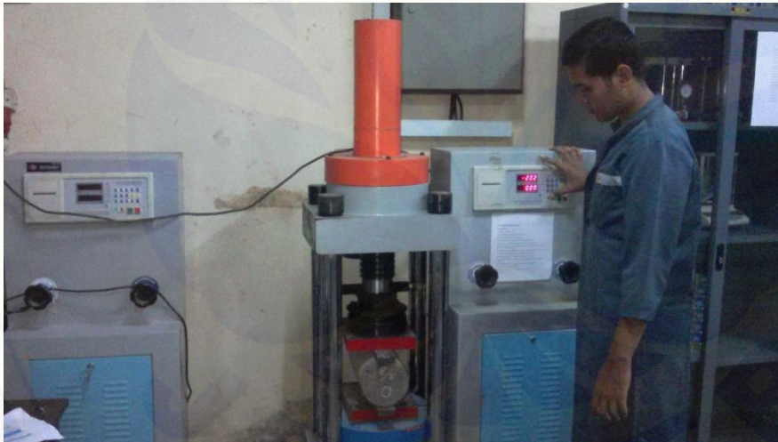
Gambar F.10 Pengujian kuat tarik belah
