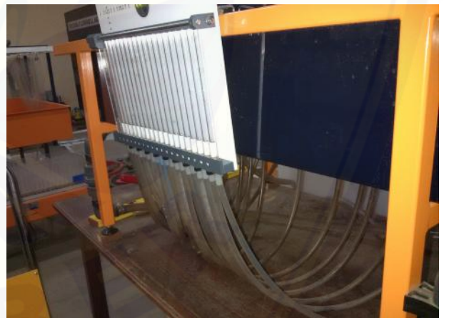
Pastikan gelembung udara keluar pada manometer
