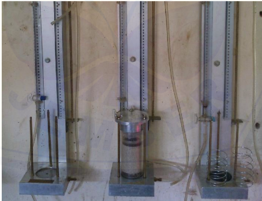
Pengaturan sampel pada permeameter
