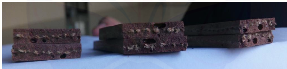
Gambar 4.13 Foto makro yang menunjukkan void pada spesimen.
