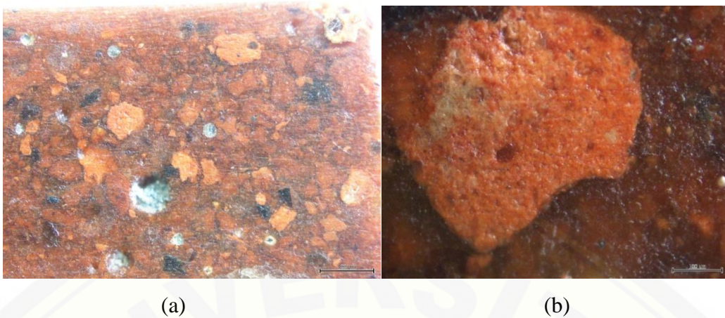
Gambar 4.16 (a) Foto mikro spesimen perbesaran 40x (b) Foto mikro gumpalan resin yang miskin MMT perbesaran 200x.
