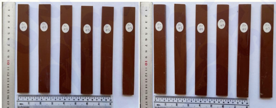
(i) Siklus thermal 0x kadar MMT 40% (j) Siklus thermal 25x kadar MMT 40%
