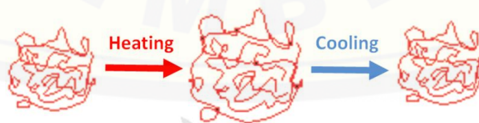
Gambar 4.17 Mikrostruktur selama proses pemanasan dan pendinginan pada material termoset (Sumber: Rizqi, 2008).
