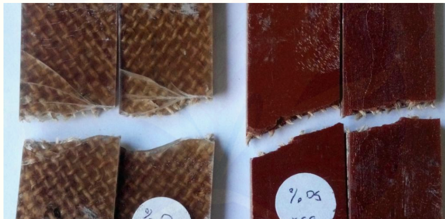
Gambar 4.20 Patahan yang terjadi antara komposit 0% MMT dan komposit berpenambah MMT.
