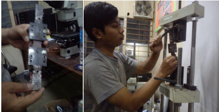
Gambar 4.8 Pencekam spesimen untuk uji tarik dan proses pemasangan spesimen pada alat uji tarik.
