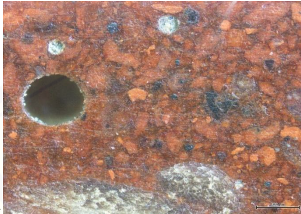
Gambar 4.14 Foto mikro menunjukkan void pada spesimen perbesaran 40x.
