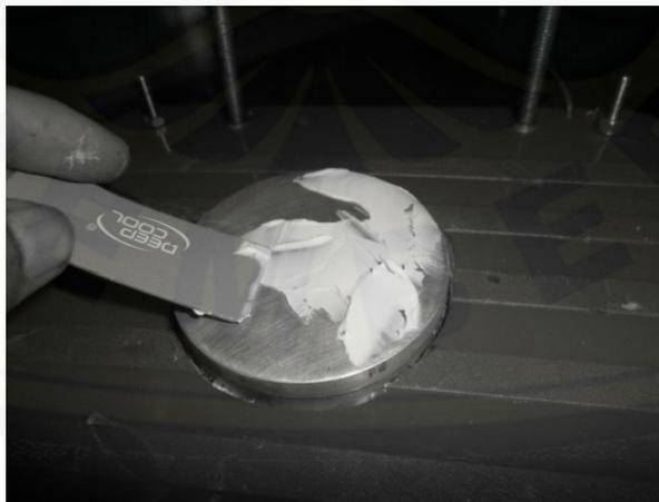
Proses pemberian *thermal paste* untuk *heatsink* panas
