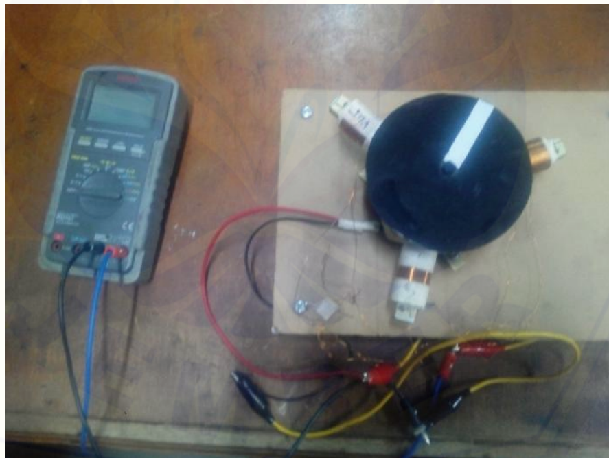
Gambar 4.3 DC Test pada posisi medan
