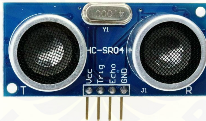
Gambar 2.7 Modul dan Koneksi Sensor Ultrasonik
